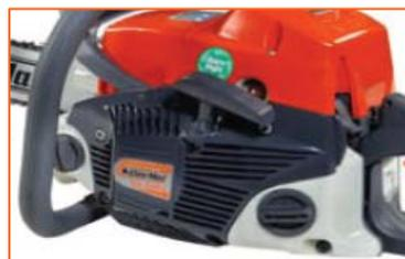
**Support carburateur avec 4 dispositifs anti-vibrations** : assure la stabilité de la carburation dans toutes les conditions de travail et une plus longue durée du carburateur .
