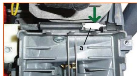
Cache-filtre intégré dans le capot moteur : permet de procéder à l'inspection et à l'entretien en déposant les 3 vis de fixation .
