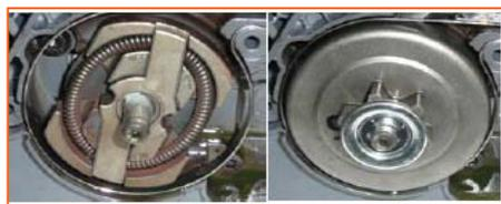
Grand levier de freinage par inertie, de type ergonomique et avec point de fixation du bloc moteur : conçu pour assurer l'enclenchement correct en toutes conditions et positions de travail.
