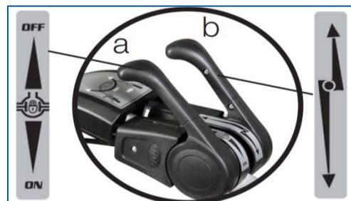
Le système de liaison **Quick-Fit** permet de **fixer rapidement et sans outils** les différents équipements sur la prise de force. (sarclofraise, barre de coupe, etc...).
