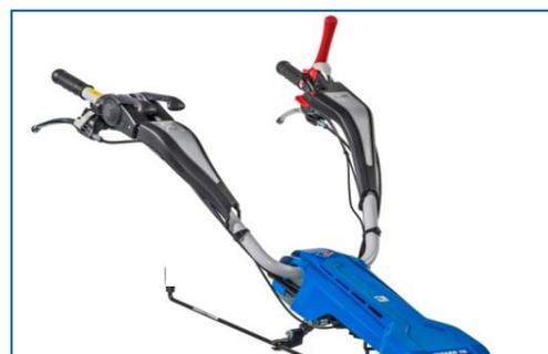
**Guidon réglable en déport** sur 3 positions (levier d).
