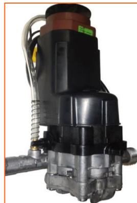
**Pompe en aluminium** avec 3 pistons axiaux en acier (b) et système "Total stop" (c).
